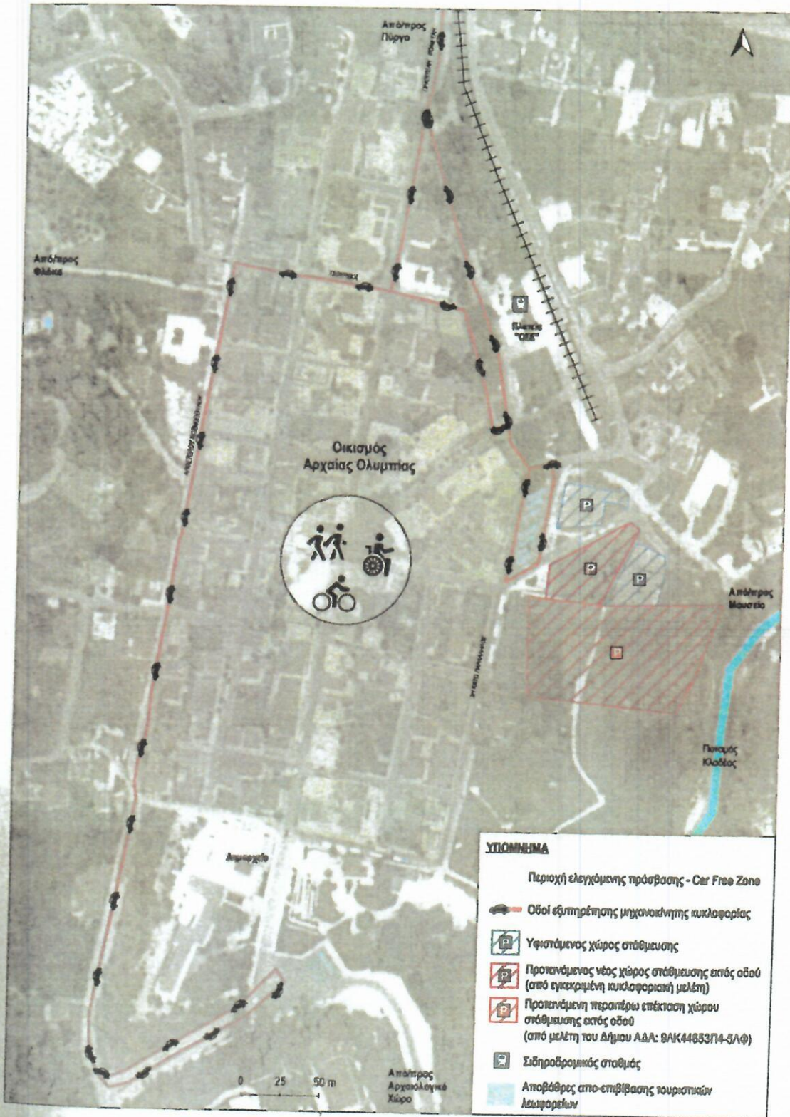
Εικόνα 15: Ενδεικτική απεικόνιση περιοχής Ελεγχόμενης Προσβασιμότητας (Car Free Zone) στον οικισμό και διάδρομοι διέλευσης μηχανοκίνητης κυκλοφορίας
